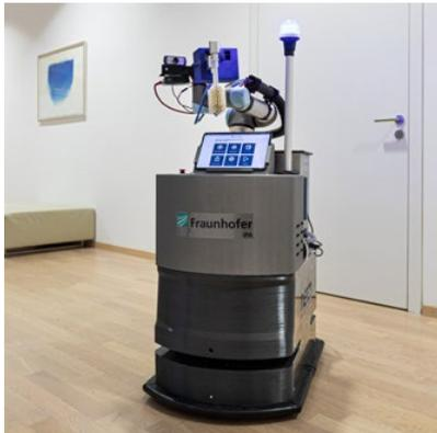
**Für den Regelbetrieb wird das Tablet am Roboter befestigt und dieser fährt selbstständig von einem zu reinigenden Objekt zum nächsten.**
