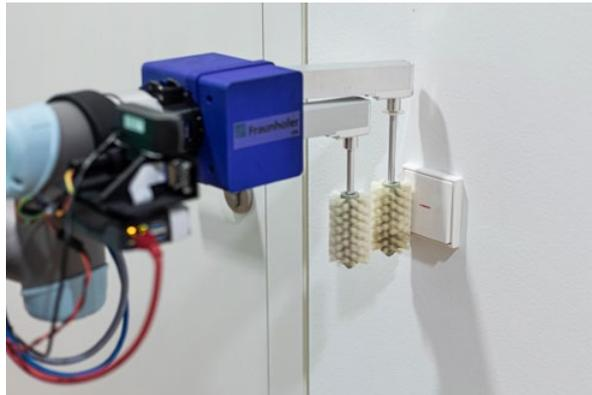
**Mithilfe seines flexiblen Reinigungswerkzeugs kann DeKonBot 2 unterschiedliche Oberflächen desinfizieren, neben Türklinken und -knäufen auch Aufzugknöpfe oder Lichtschalter.**
