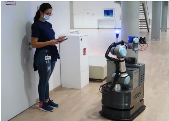
**Während der Praxistests konnten Reinigungskräfte den Roboter über ein Tablet einlernen.**
