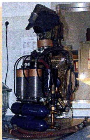
Dräger Rettungsapparat Modell 1904/09, Drägerwerk Lübeck, 1906 mit alterungsbedingten Schäden an Gummischläuchen
