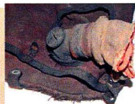
Durch Alterung verfestigte und abgerissene Schlauchverbindung am Atemsack eines Rettungsapparates
