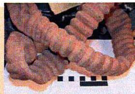
Durch Alterung verfestigter und deformierter Gummi-Textil-Schlauch
