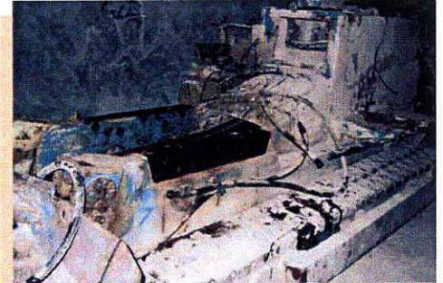
Teilschnittmaschine Alpine Miner AM 50; die Maschine, übernommen aus einem stillgelegten Salzbergwerk, soll nach Restaurierung im Anschauungsbergwerk des Deutschen Bergbau-Museums ausgestellt werden.
