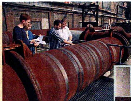
Überprüfung der Wirksamkeit von verschiedenen transparenten Beschichtungssystemen auf korrodiertem Untergrund (Rohrleitungssystem der Henrichshütte in Hattingen)
